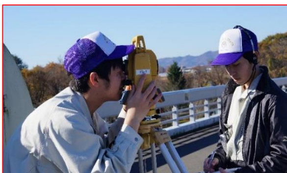
TSにより船舶の水平位置を測定
