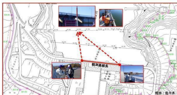
図3 湖面を移動する船をTSで観測する
