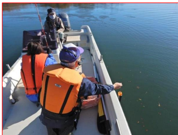
船には、TS視準用ピンポールと測深器を設置
